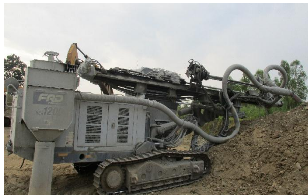
รูปที่ 2-25 เครื่องเจาะระเบิดที่มีอุปกรณ์เก็บฝุ่น
